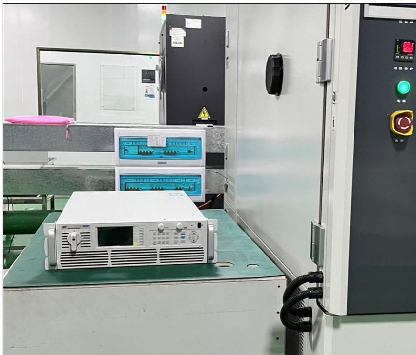
SP-3U/6U 系列电源具有高精度、高稳定性、CC 模式、模拟输出工况等性能，对新能源汽车元器件进行长时间的质量、性能测试。
